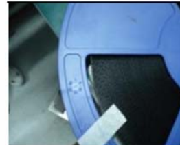
图 3: 将 1 个卷盘放入防潮袋中, 并放入一包干燥剂 (1 unit/包), 不需要湿度显示卡。
