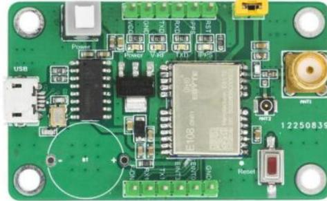
1. 接好 GPS 天线后，同时通过 USB 线连接电脑，板子的天线对侧有 USB 口，再按开关按钮开机。
