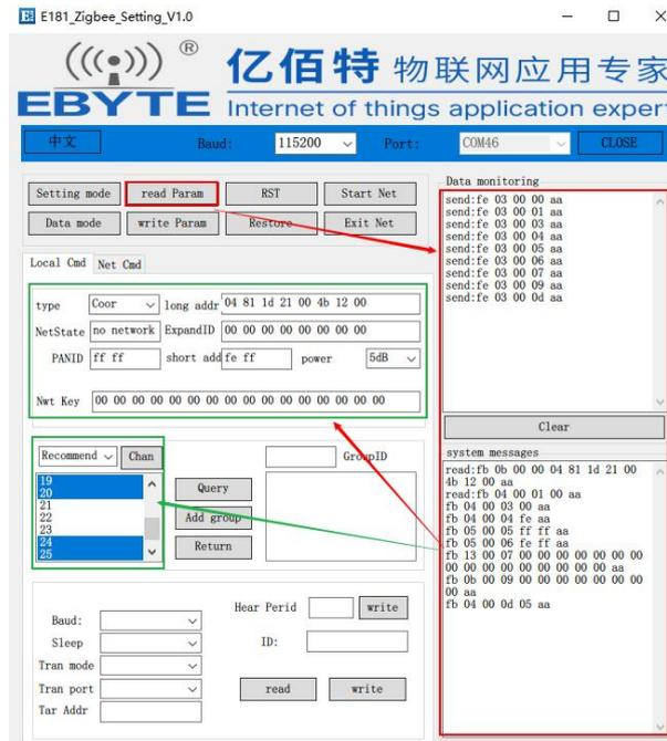
4. 选择节点类型为协调器，并写入参数。然后点击**重启模组**读取为协调器后成功，再次读取参数，点击配置网络等待协调器开始组建网络，用户可查看模块参数。网络组建好读取参数：配置网络参数：
