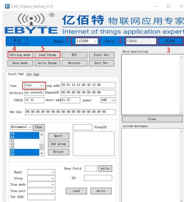
3. 点击进入配置、读取参数，读取相应模块参数。
